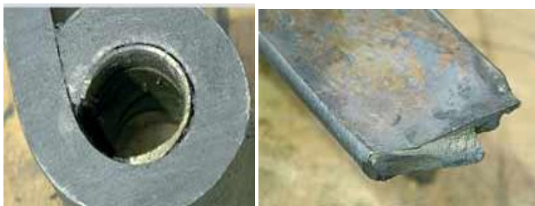
Figura 1: Peças com defeito - Buchas com desgaste e Lâmina quebrada
